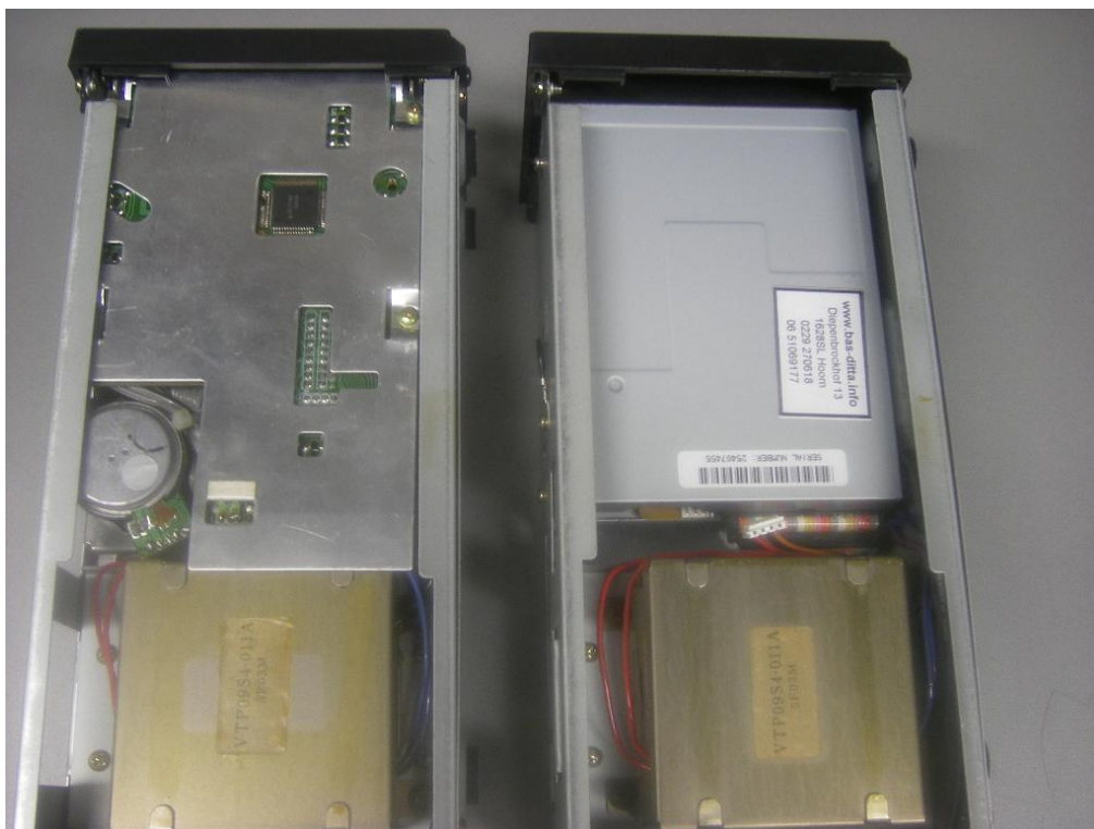
Links de originele enkelzijdige diskdrive, rechts de nieuwe dubbelzijdige diskdrive.
