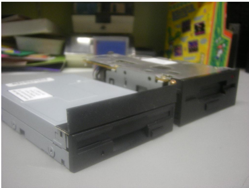
Links de dubbelzijdige diskdrive met hoekprofiel, rechts de originele enkelzijdige diskdrive.
